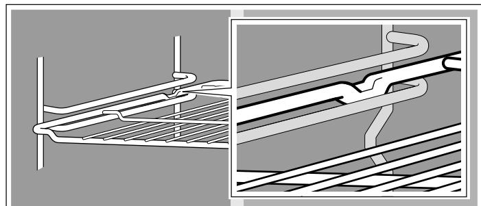
С помощью выдвижных направляющих на уровнях 2 и 3 можно выдвигать принадлежности на большее расстояние.
