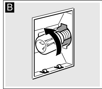
3. Выверните лампочку и замените её на лампочку того же типа (рис. В). При вворачивании следите за тем, чтобы лампочка была вставлена прямо.
