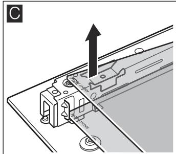
5. Приподнимите нижнее стекло и выньте его движением вверх.
